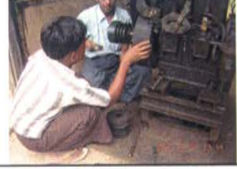
ペタエンジンのクラッチブリーの再設置
