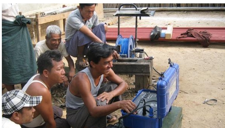
プウィンリン村 ボアホールカメラ孔内撮影（5月）
