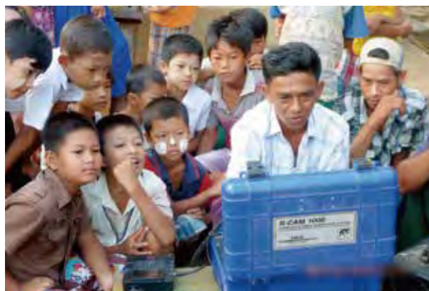
ユワマ村井戸修繕。故障原因を探るため特殊カメラを井戸に潜行中
