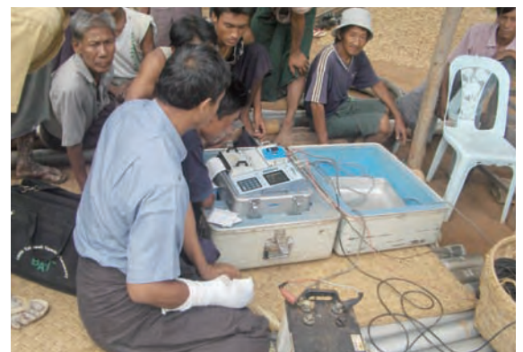
水脈がどこにあり、どのような成分構成になっているのかをチェック
