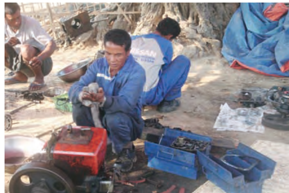
塩水を被ったエンジン修理のため、モバイル・メカニカル・ワークショップを開催
