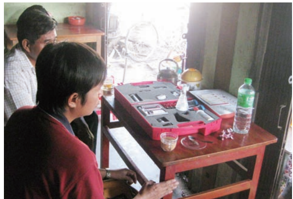
水質検査キットを使って井戸水をチェック
